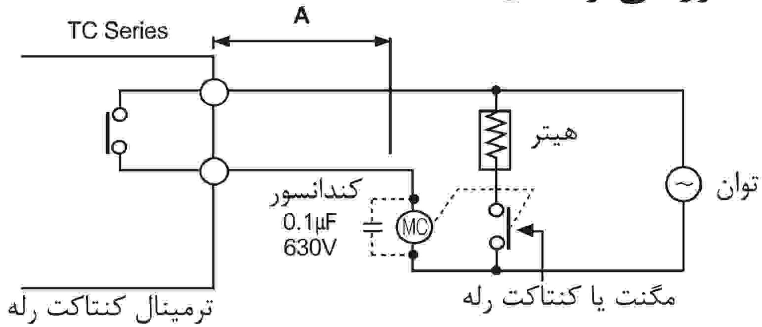
در زمان سیم کشی کنترلر به بار در فاصله A را تا امکان بلند در نظر بگیرید. اگر فاصله A کوتاه باشد، نیروی محرکه مخالف حاصل از سیم پیچ و مگنت کلید و رله قدرت ممکن است اثر مغناطیسی روی تغذیه دستگاه بگذارد و باعث عیب در دستگاه بشود.
