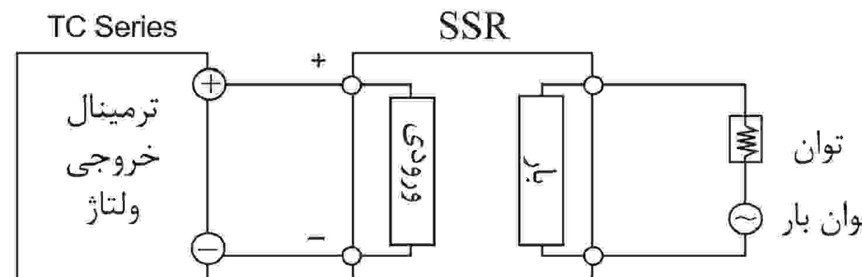
\* رله SSR باید متناسب با بار در نظر گرفته شود در غیر اینصورت ممکن است باعث اتصال کوتاه و آتش سوزی شود. گرمادهی غیر مستقیم باید به وسیله SSR به علت کارایی مناسب تر انجام شود.
