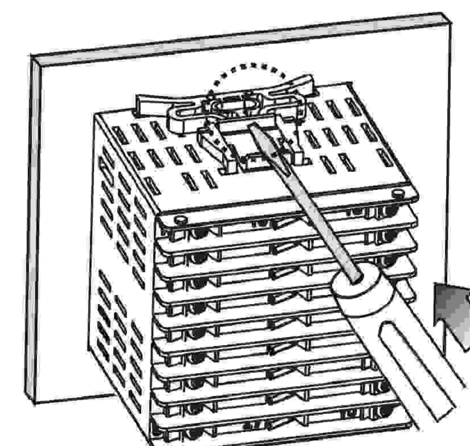
\* قطعه را روی پنل نصب کرده و گیره ها با فشار دادن با ابزار مناسب طبق تصویر بالا سفت کنید.
