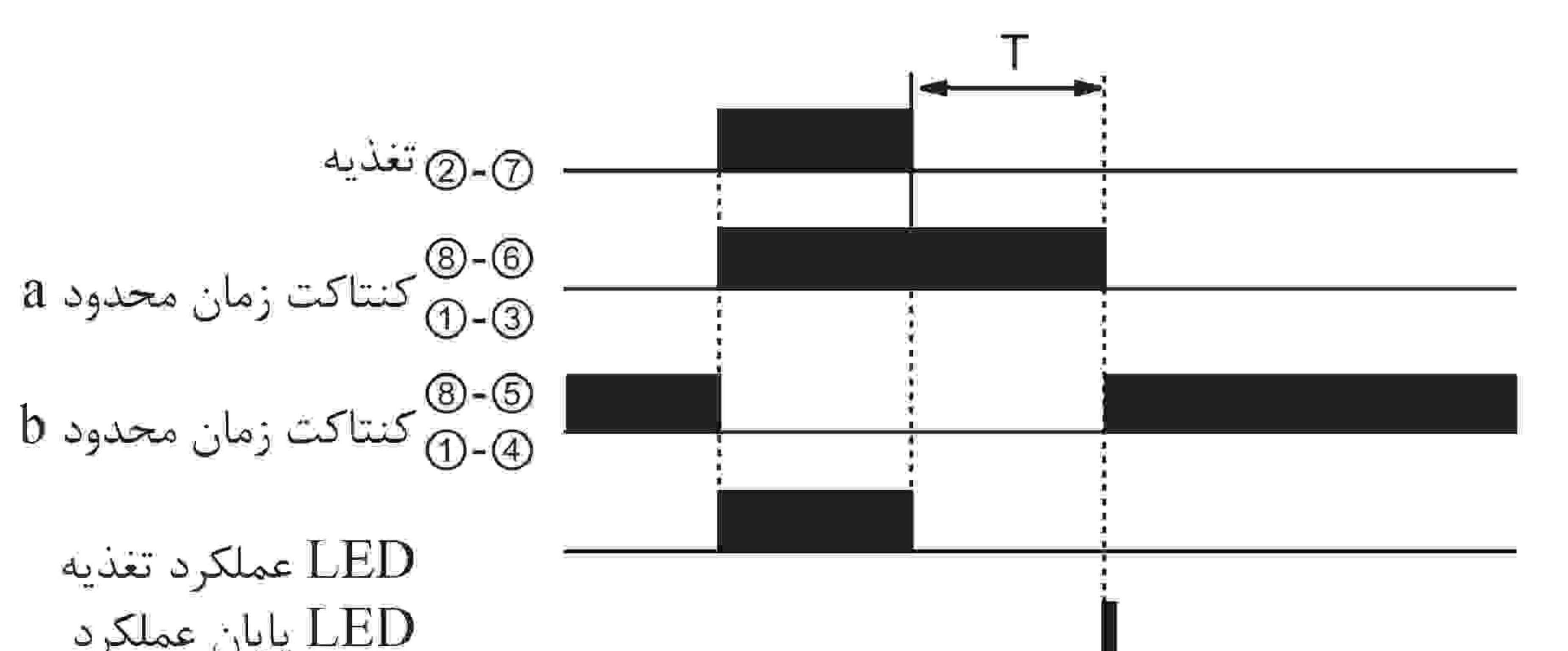
کنکات a زمانی که تغذیه به تایمر اعمال می شود، وصل شده و پس از سپری شدن زمان تنظیمی (T) با قطع تغذیه، قطع می شود. یک فانکشن نگهداری از حافظه هم وجود دارد. حتی اگر پس از قطع تغذیه زمان تنظیمی را تغییر دهید، کنکات زمان محدود a پیش از قطع شدن تغذیه، قطع می شود.
